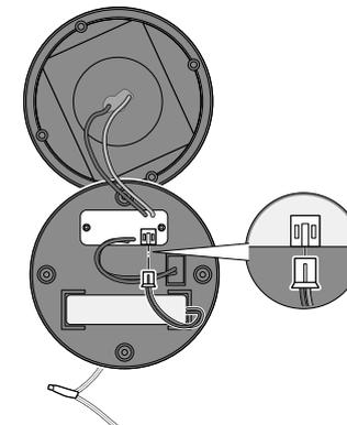
4. Démontez les parties supérieure et inférieure du boîtier électronique.
